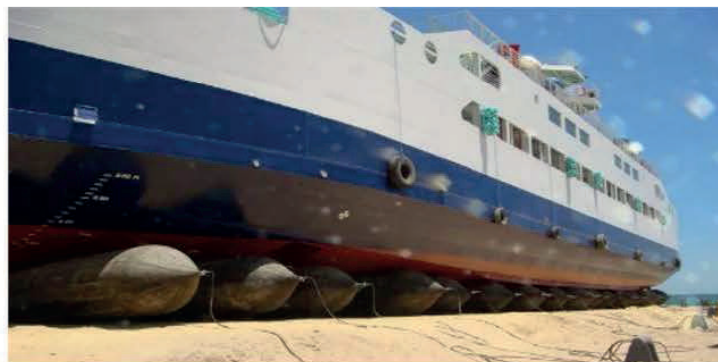
Sistema de lançamento por "air bags" até 3500 ton
